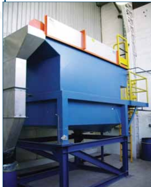
Planta de efluentes fosa de pinturas (Con este sistema los lodos son más secos)
