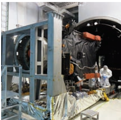
MODELO de vuelo en acústico-Arsat I.
